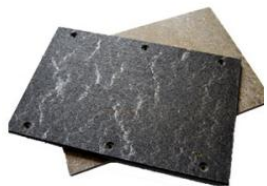
Pannelli in sansa di olive esausta e plastica ricicla Ecomat ed Ecomat V
