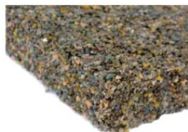
Massetto alleggerito con polimeri riciclati dosato a 150kg/mc di cemento ECOLIGHT
