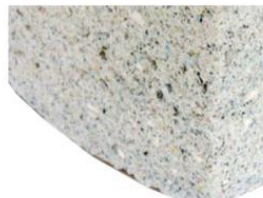
Massetto alleggerito con polimeri riciclati dosato a 300kg/mc di cemento ECOMIX
